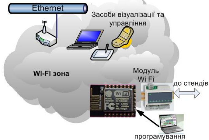
Рисунок 3 – Інтеграція модуля Wi-Fi в структуру стендів
