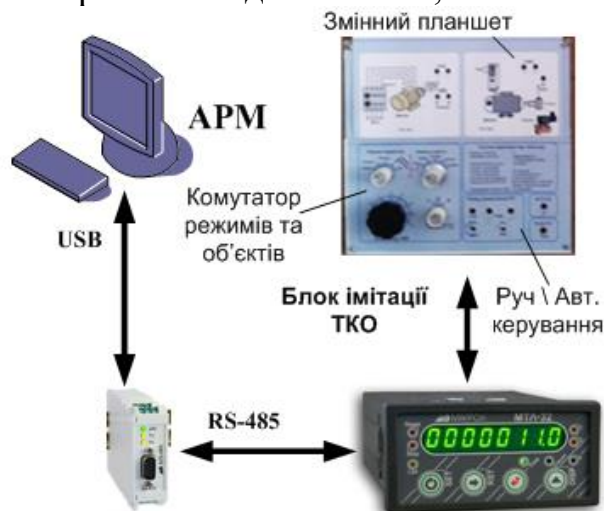
Рисунок 3 – Дворівнева структура установки дослідження МТЛ-32
