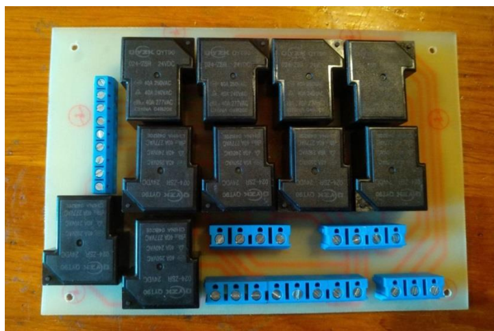
Рисунок 3.10 – Зовнішній вигляд плати силових реле управління термостатом
