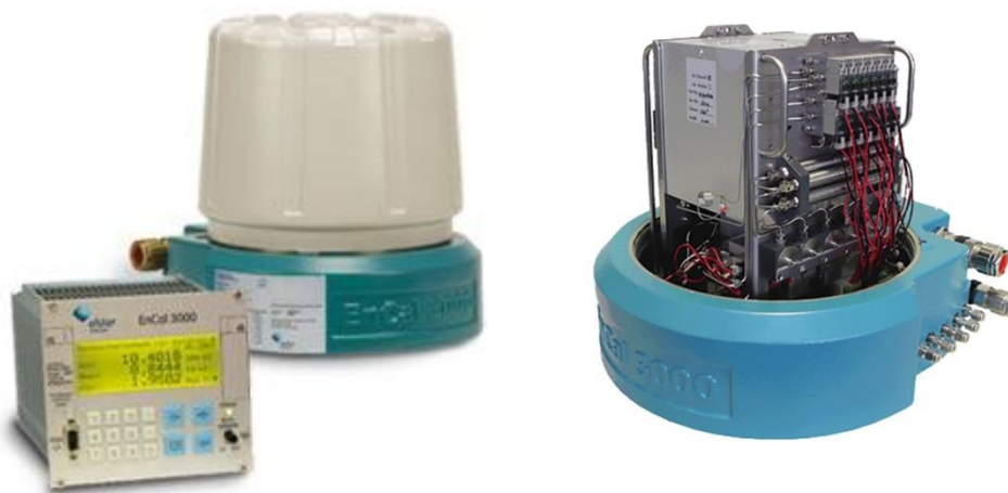
Рисунок 1.20. Хроматограф газовий Encal 3000 HCDP в зборі і зі знятою кришкою
