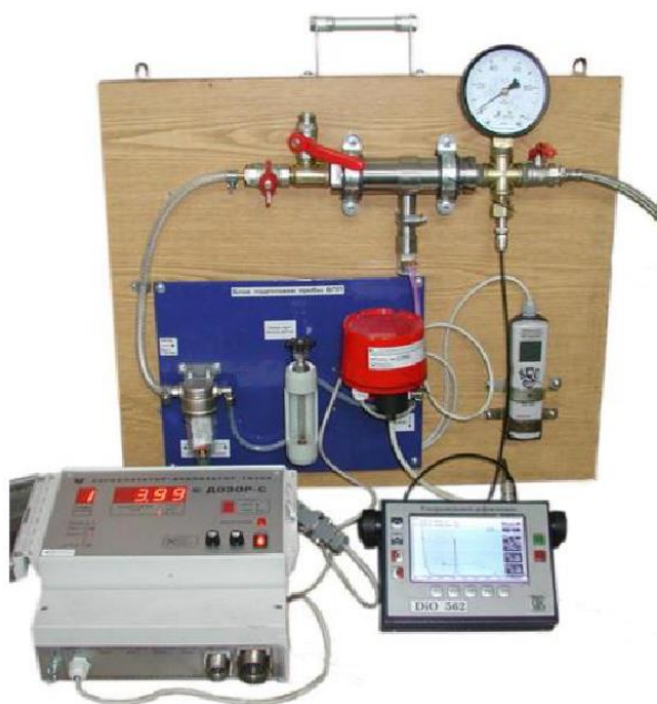
Рисунок 1.17 Експериментальна установка для визначення теплоти згоряння газу розробки ІФНТУНГ
