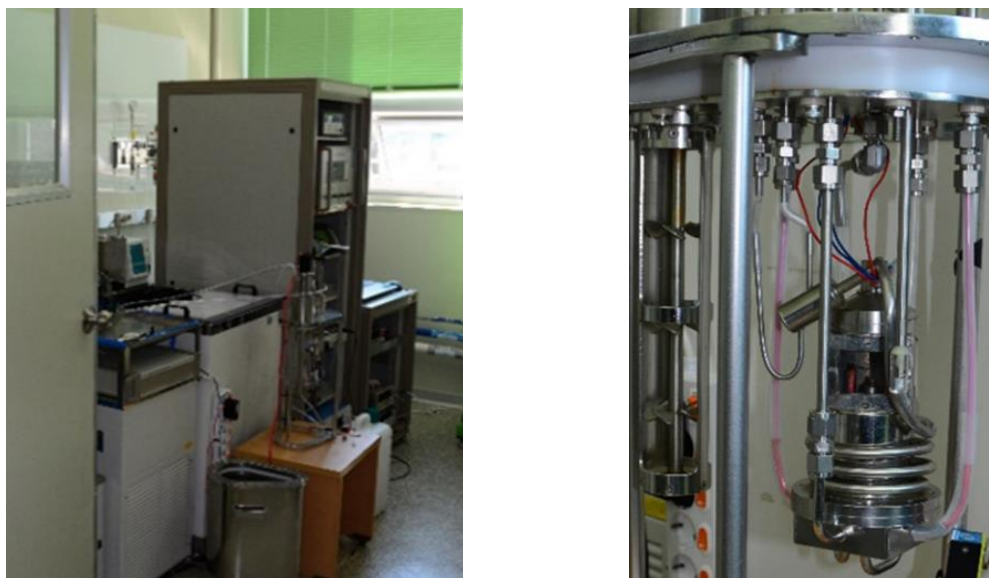
Рисунок 1.11 Конструкція лабораторного калориметра KRISS [74]
