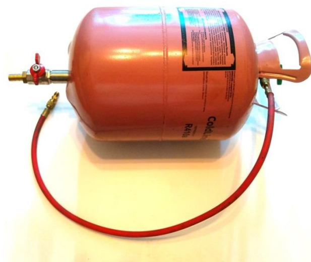
Рисунок 3.32 – Пробовідбірник на основі балона для фреону типу R410A.
