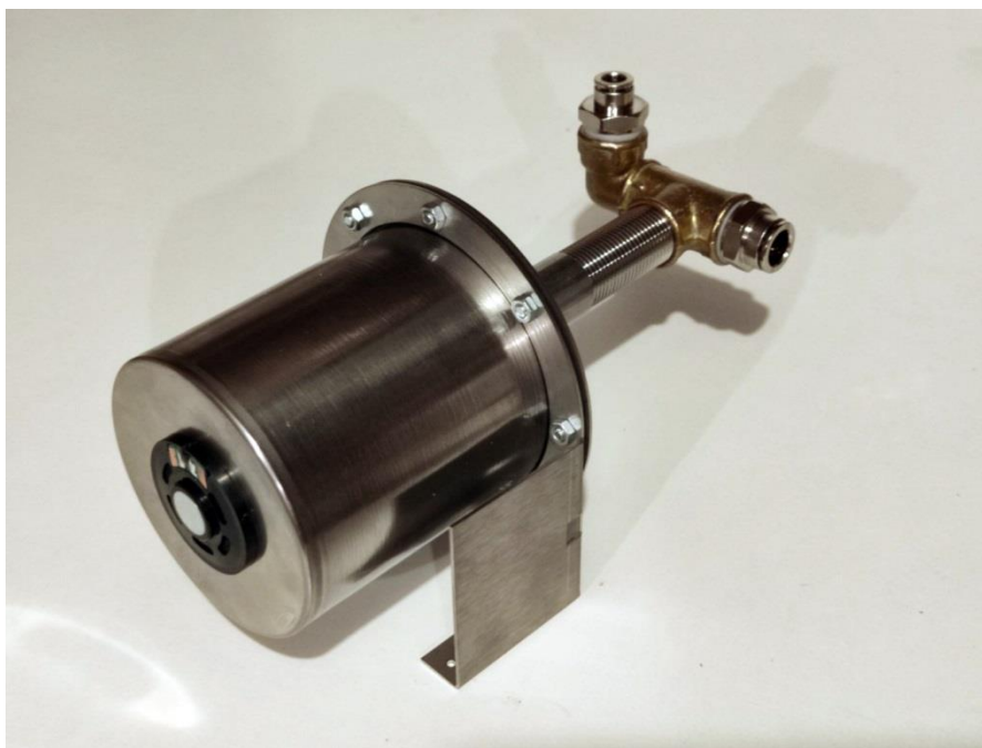
Рисунок 3.15 – Загальний вигляд резонатора з акустичним випромінювачем
