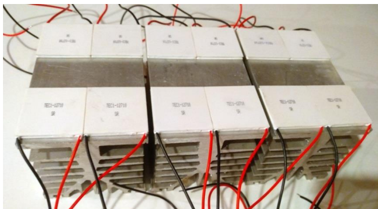
Рисунок 3.4 – Елементи Пельтьє, встановлені на радіатори
