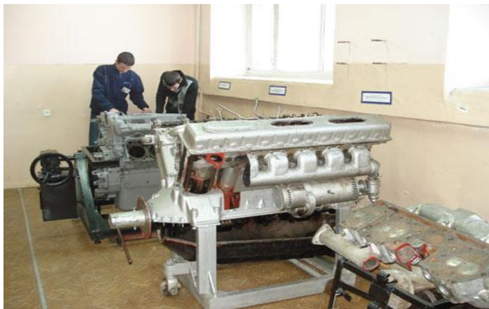
Студенти на лабораторному занятті виконують регулювання теплових зазорів газорозподільного механізму двигуна
