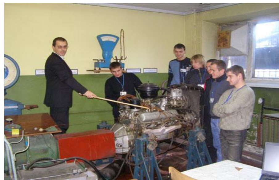
Визначення на лабораторному занятті потужності двигуна
