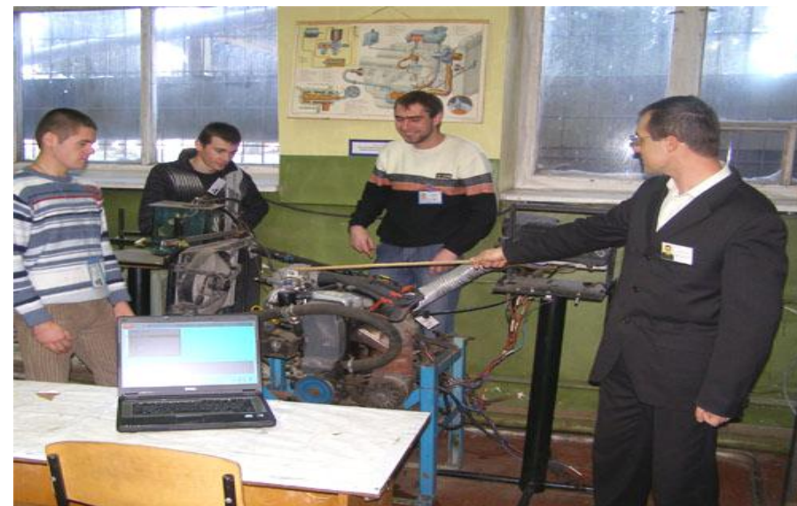
Студенти вивчають будову електронної системи впорскування бензину двигуна Ford
