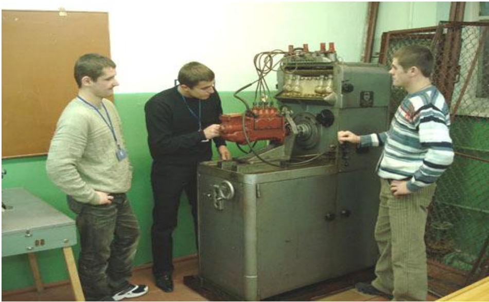
Студенти вивчають роботу паливного насосу високого тиску на стенді
