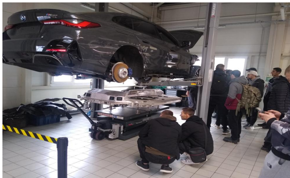
Заняття з демонтажу високовольтної АКБ з автомобіля БМВ
